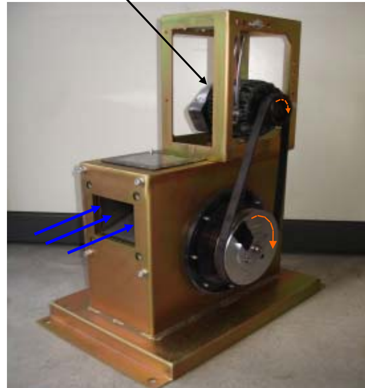
発電機本体(カバー無し)
